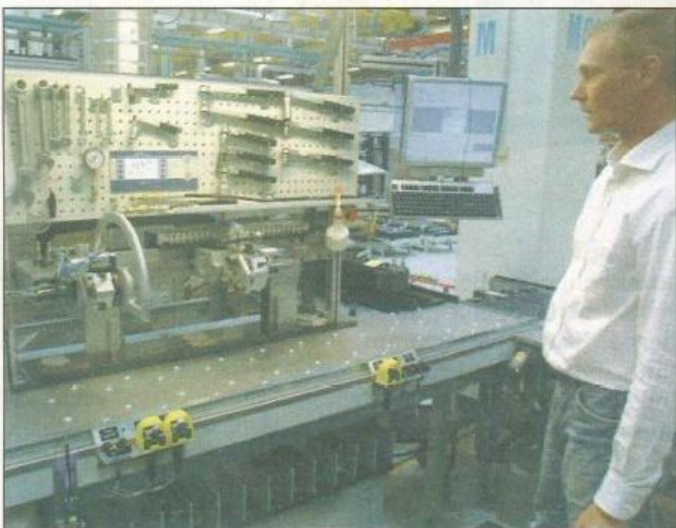
Proportional-ventilerne fra Sauer-Danfoss har til opgave at styre det hydrauliske tryk i et hydraulisk system, og de bliver alle testet i avancerede testbænke inden de sendes til kunden.
