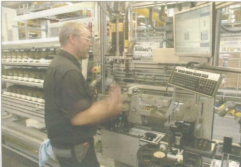
ERP-systemet SAP leverer produktionsdata til Guide online, som styrer styklisterne og genererer de recepter, der skal styre montagen. Operatørpanelet, som er placeret ved hver af de i alt ti arbejdspladser, guider via billeder og tekst operatørerne til hvilke dele, der skal monteres hvornår og hvor.
